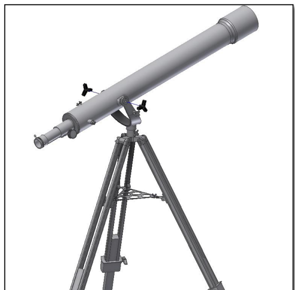
Abbildung 5. Den Tubus mit den mitgelieferten Griffschrauben befestigen.
