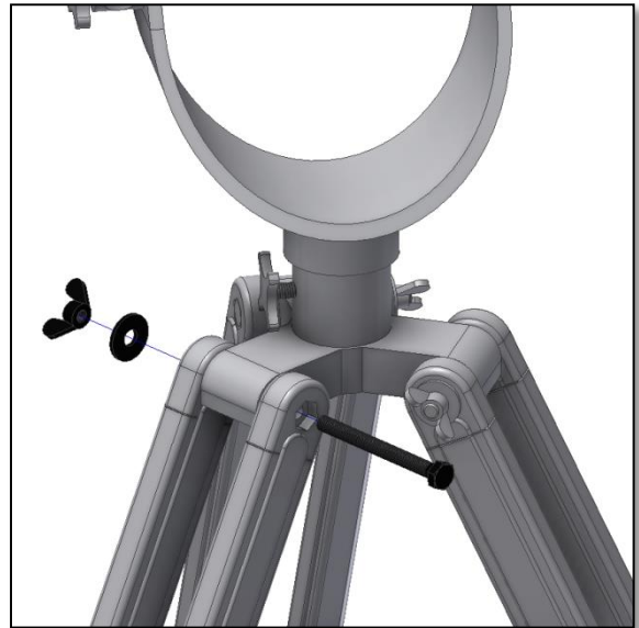
Abbildung 3. Stecken Schraube, Scheibe und Schraubenmutter an.
