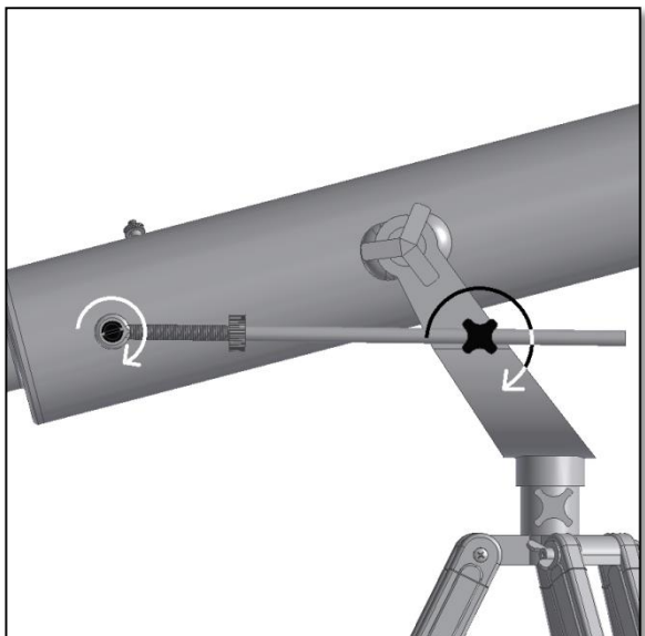
Abbildung 7. Feineinstellwelle fertig montiert.
